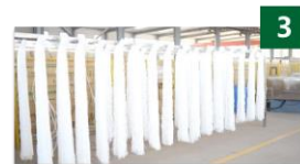
3.中空纤维超滤膜 生产车间
